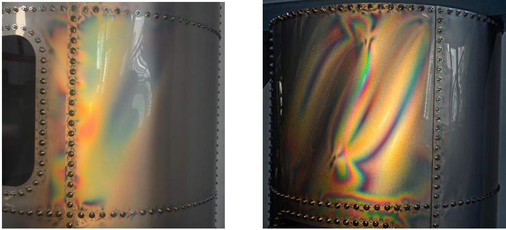
Rys.8 Rozkłady efektów optycznych w rejonie wykroju (po lewej) oraz w segmencie pokrycia powyżej wykroju (po prawej)
