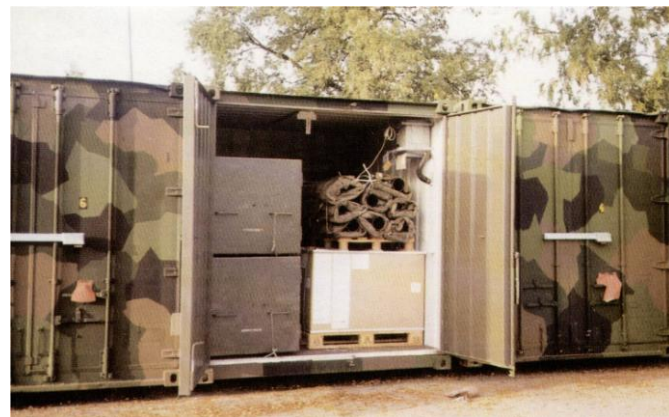
Rys. 3. Kontener osuszany dynamicznie
