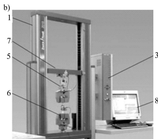
Rys. 1. Wygląd maszyny wytrzymałościowej Zwick/Roell Z1010; a) widok ogólny, b) przestrzeń robocza: 1 – rama, 2 – komora cieplna, 3 – jednostka sterująca, 4 – pilot sterujący, 5 – uchwyt górny, 6 – uchwyt dolny, 7 – ruchoma belka, 8 – ekran komputera
