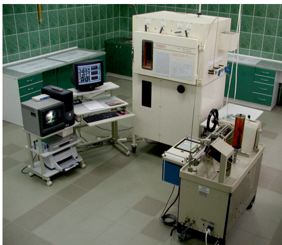
Rys. 4. Aparatura PVT użyta do badań [26] wraz z komorami wysokociśnieniowymi [27]
