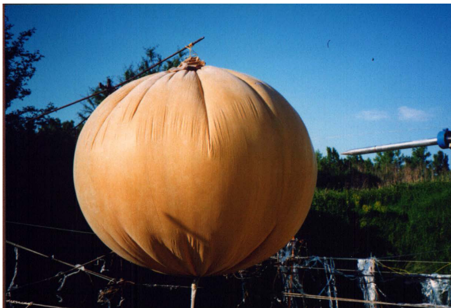
Rys. 1. Widok balonu i czujnika pomiarowego ( V_a = 0,371 \text{ m}^3 )
