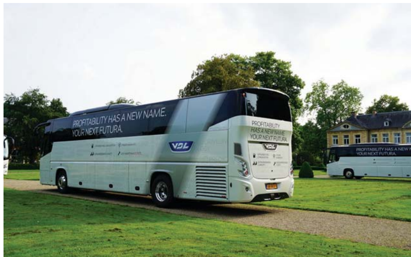
Jedyną zauważalną różnicą jest powiększona krata wlotu powietrza do silnika, znajdująca się na zwisie tylnym, po lewej stronie autobusu
