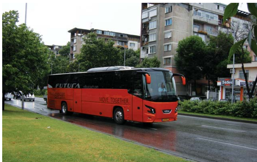
Futura 2 w wersji MD z nadwoziem niższym o 20 cm niż w wersji HD
