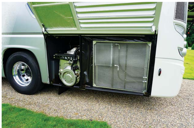
Chłodnica silnika została przeniesiona na lewą stronę autobusu (w porównaniu z autobusami z silnikami Euro 5)
