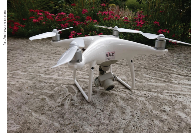
Fot. 1. Wykorzystany w badaniach bezzałogowy statek powietrzny – DJI Phantom 4 PRO V2.0 [archiwum autora]
