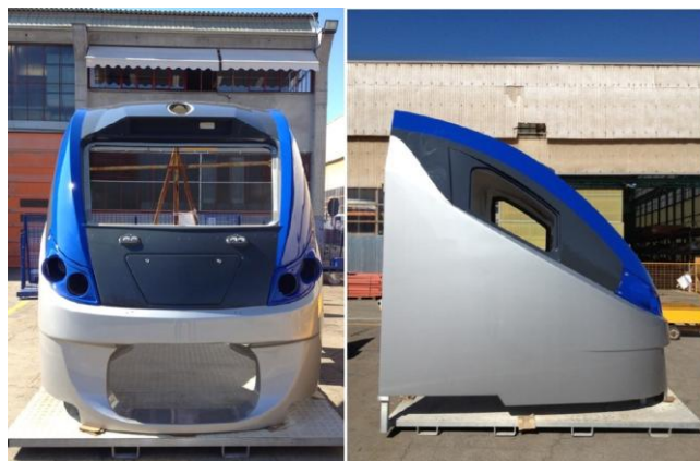
Rys. 6. Kabina przednia szybkiego pociągu Trenitalia produkcji firmy Kompozyty (Polska, Stanowice).
