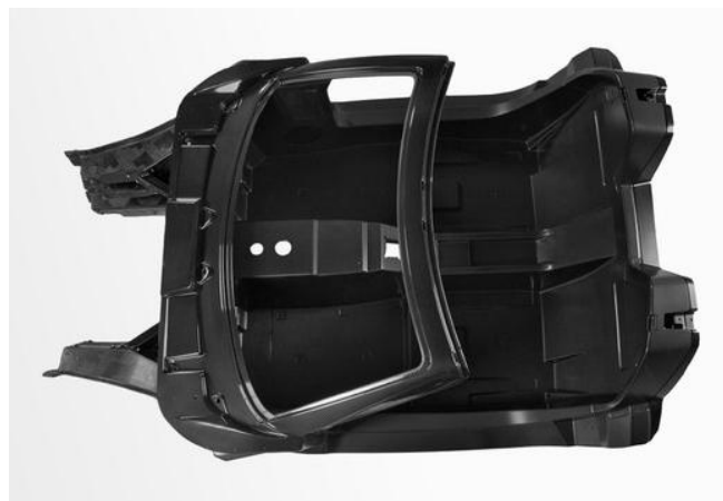
Rys. 9. Plyta podłogowa samochodu sportowego Roding Roadster produkcji firmy Roding Automobile GmbH (Niemcy) wykonany z kompozytów polimerowych [23].
