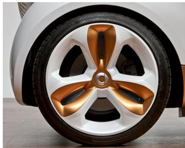
Rys. 10. Osłona koła wykonana z materiału kompozytowego wytworzona przez firmę BASF (Niemcy) [25].
