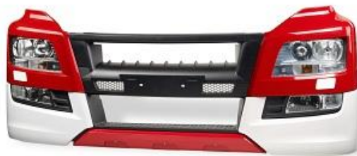
Rys. 5. Modułowy pas przedni samochodu ciężarowego MAN [18]
