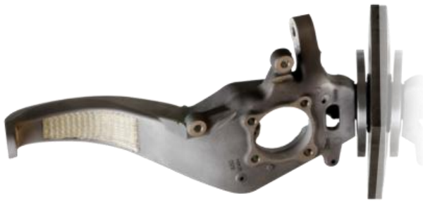
Rys.14. Wahacz samochodu osobowego wykonany przez firmę 3M (USA) ze stopu aluminium umacnianego włóknem Nextel™ [28]
