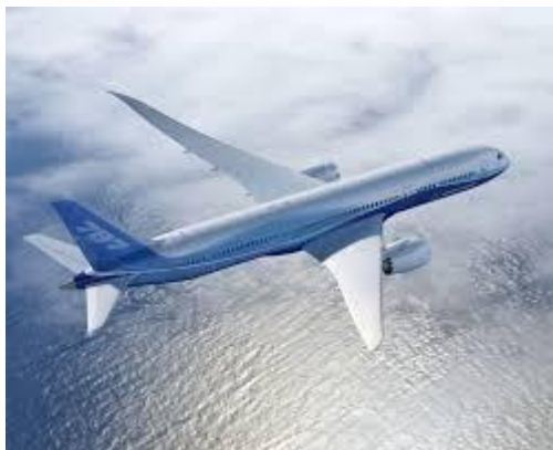
Rys. 4. Samolot pasażerski Boeing 787 Dreamliner w budowie którego zastosowano ok. 50% kompozytów polimerowych [16].
