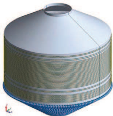
Rys. 5. Zastępcze obciążenie liniowe od sprężenia
