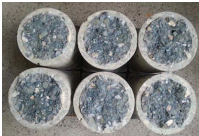
Rys. 4. Badanie wytrzymałości betonu na osiowe rozciąganie (z lewej), przełom próbek (z prawej)
