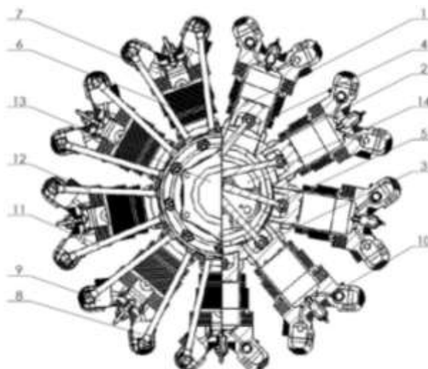
Rys. 1. Budowa silnika gwiazdowego: 1 - tłok, 2 - pierścień tłokowy, 3 - sworzeń tłokowy, 4 - korbowód, 5 - wał korbowy, 6 - cylinder, 7 - głowica, 8 - pokrywa głowicy - kanał dolotowy, 9 - pokrywa głowicy - kanał wylotowy, 10 - świeca zapłonowa, 11 - popychacz zaworu wydechowego, 12 - popychacz zaworu dolotowego, 13 - pokrywa tylna silnika, 14 - pokrywa przednia silnika. Źródło: Opracowanie własne
