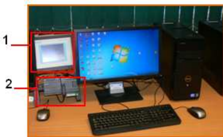
Rys. 1. Podstawowe stanowisko dydaktyczne: 1 – dotykowy panel, 2 – sterownik PLC
