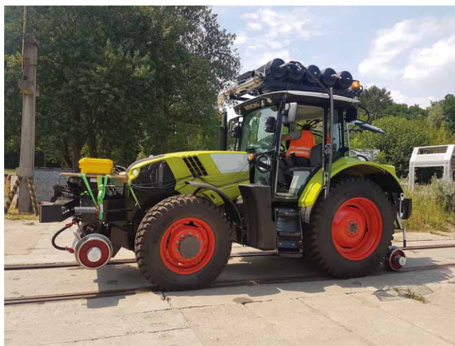
Rys. 1. Ciągnik szynowo-drogowy z podłączoną aparaturą badawczą
