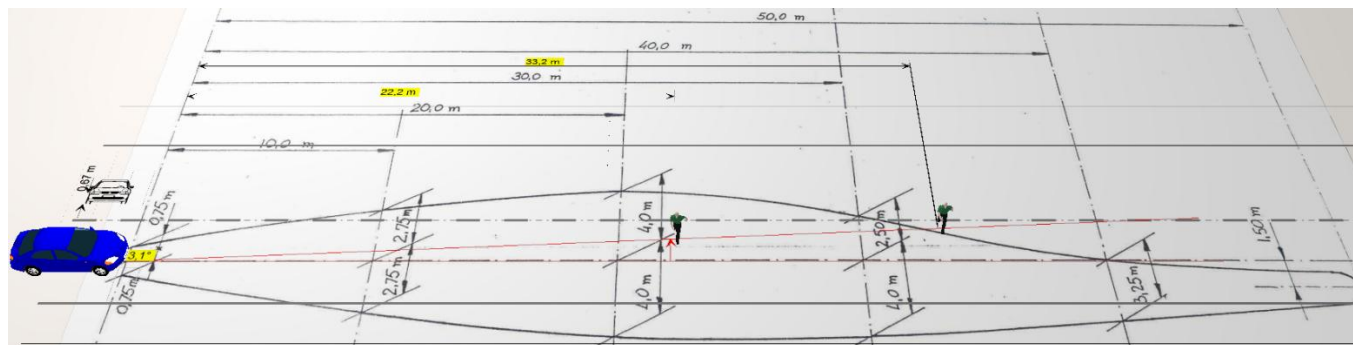
Rys. 9. Obliczone parametry odległościowe widoczności przeszkody w światłach mijania. Źródło: [opracowanie własne].
