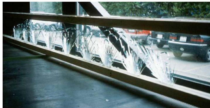
Rys. 3 Przekrój belki wykonanej przez J. Hamm'a (po lewej) oraz widok zniszczonej belki (po prawej) [8].
