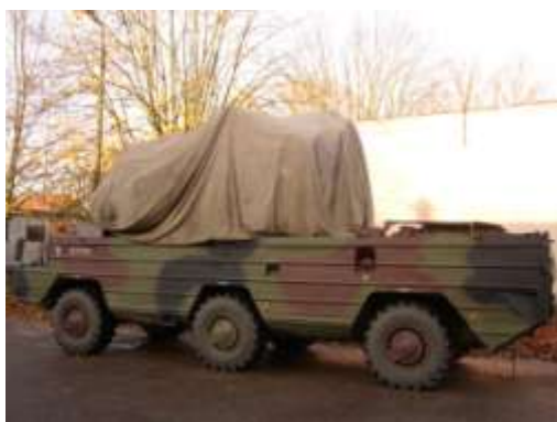
Rys. 11. Widok pojazdu 3 osiowego z wszystkimi osiami skrętnymi typu BAZ [11]
