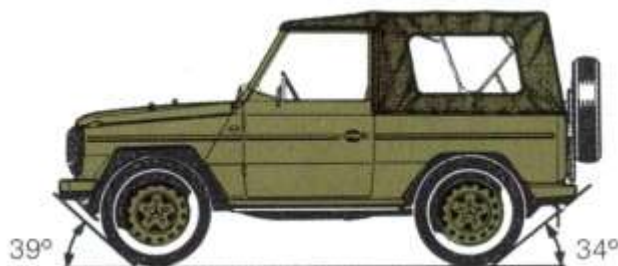
Rys. 4. Kąty natarcia i zejścia samochodu Mercedes 290 GT
