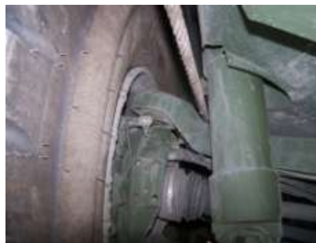
Rys. 14. Fragment napędu terenowego na przednią oś [11]
