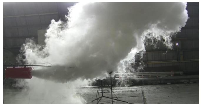
Rys. 5. Zadziałanie generatora aerozolu gaśniczego inicjowanego pirotechnicznie (źródło: archiwum CNBOP-PIB).
