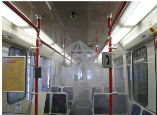
Rys 10. Przykład zastosowania systemu mgły wodnej w przedziale pasażerskim pociągu [14].
