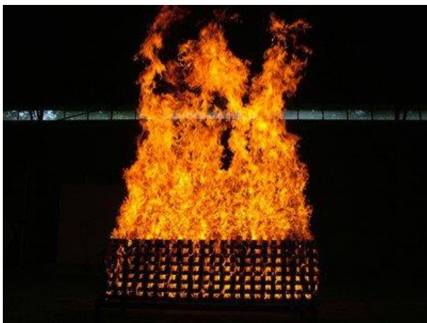
Rys. 4. Pożar testowy grupy A (źródło: archiwum CNBOP-PIB).
