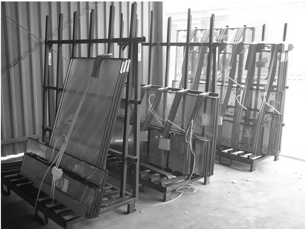
Rys. 7.3 Przykłady różnego pakowania, różnych priorytetów pakowania szyb na stojakach typu „L”
