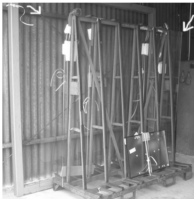
Rys. 7.2 Stojak typu piramida, przeznaczony do przewożenia dużych szyb. Strzałkami zaznaczono kontury dużej szyby, wystającej po za gabaryty stojaka. Z przodu zapakowano jedną mniejszą szybę, łącząc dostawę dla tego samego klienta
