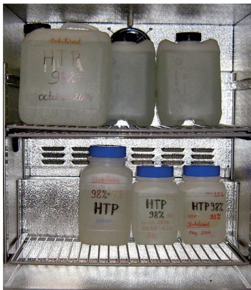
Rys. 6. Przechowywanie HTP 98%+ w chłodziarce (29 litrów, w pasywanych pojemnikach z HDPE z odpowietrzaniem) [Rarata, 2015]
