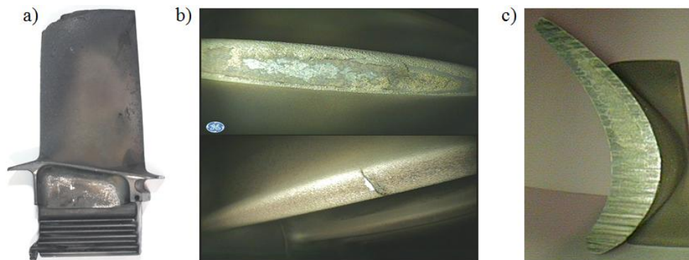
Rys. 2. Przykładowe postacie uszkodzeń chłodzonych łopatek turbin wykonanych z odlewanego nadstopu typu ŻS 32: a) przegrzany materiał przy wierzchołku [2]; b) całkowite wypalenie powłoki na krawędzi natarcia aż do odsłonięcia nadstopu oraz pęknięcie na krawędzi natarcia [12]; c) przytarcie czoła pióra łopatki [12]
