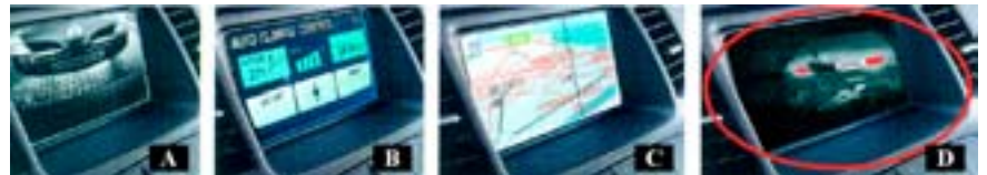
Rys. Wykorzystanie centralnych wyświetlaczy LCD w samochodzie: A – obraz z kamery cofania, B – wyświetlanie funkcji wskaźników, C – wyświetlanie systemu nawigacji satelitarnej, D – zdjęcie wykonane metodą termowizji wklejone w miejsce ekranu LCD (ze zbiorów autora)
