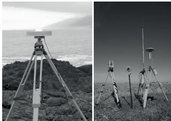
Fig. 5 GPS (static and RTK method) Rys. 5 GPR (statyczne i metodą RTK)
