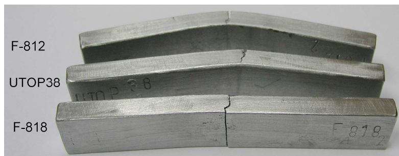
Rys. 1. Kształty próbek z całkowicie pękniętą warstwą napawaną po próbie zginania Fig. 1. The shapes of samples with completely fractured padded layer after bending tests
