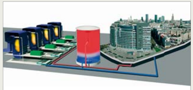
Rys. 2. Akumulator w miejskiej sieci ciepłowniczej
