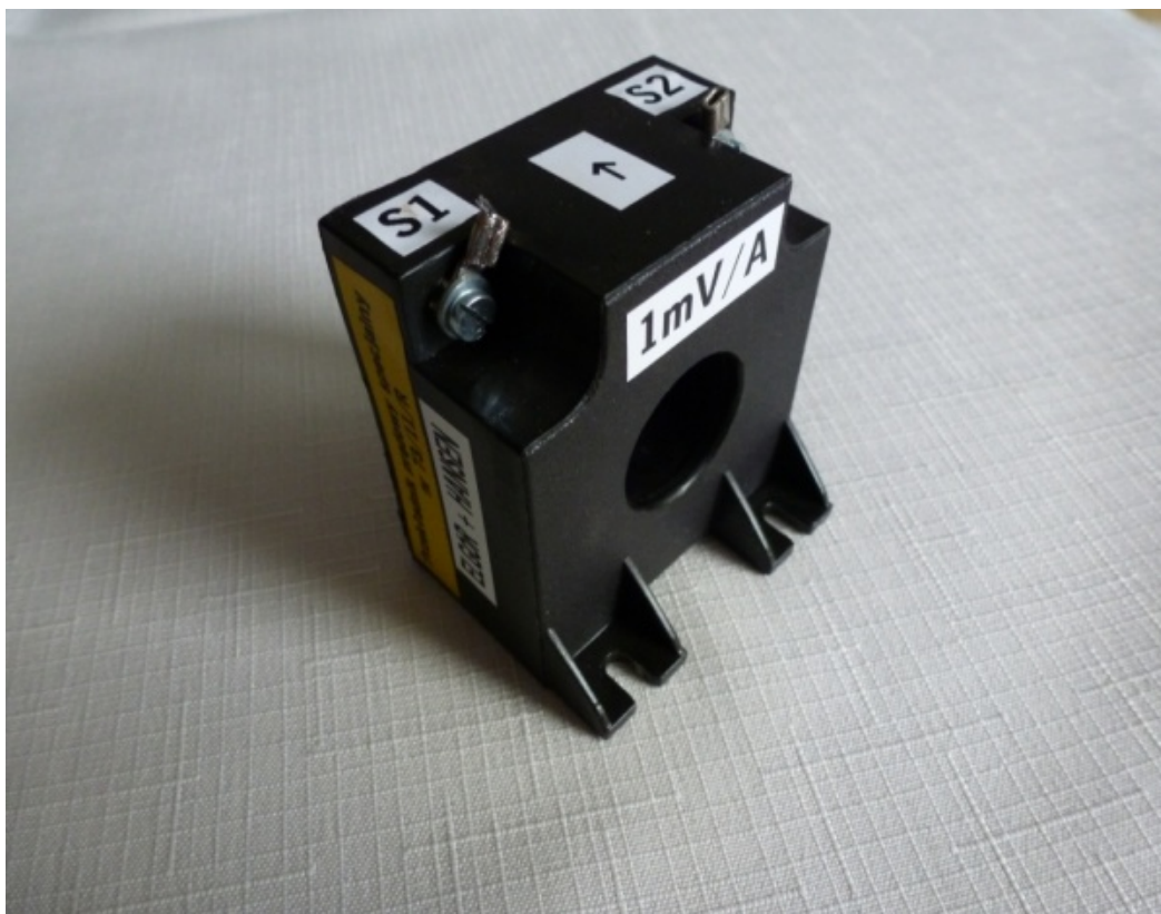
Rys. 1. Widok przetwornika prądowo-napięciowego z materiałem amorficznym
