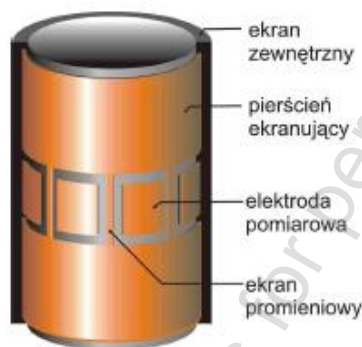
Rys. 2. Schemat jednopłaszczyznowego czujnika ECT
