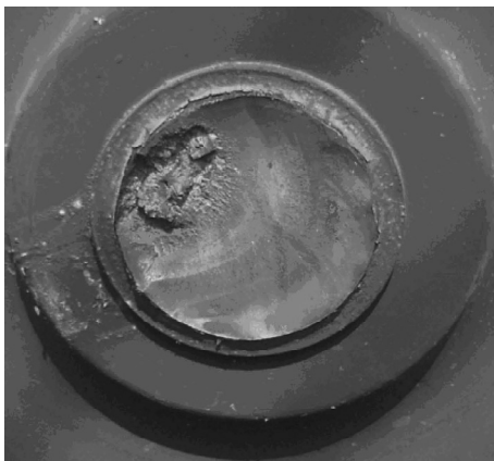
Rys. 2. Pęknięcie zmęczeniowe osi. Przyczyna katastrofy kolejowej w Viareggio 2009 r. [źródło: pismo prezesa UTK nr TTN-512-129/JN/09]
