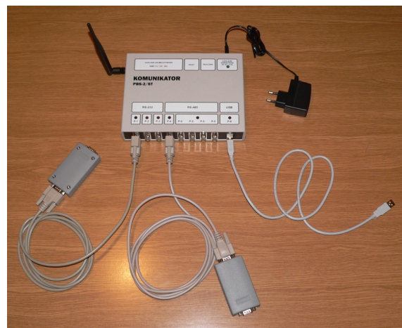
Rys. 3. Fotografia pokazująca komunikator połączony kablami z 2 modulami analogowymi Fig. 3. Photograph of the communicator connected with 2 analog modules by cables
