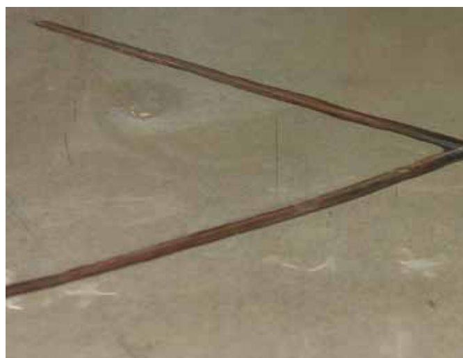
Rys. 11. Wygląd powłoki otrzymanej z BPS i IPDI po teście korozyjnym z wykorzystaniem solanki
