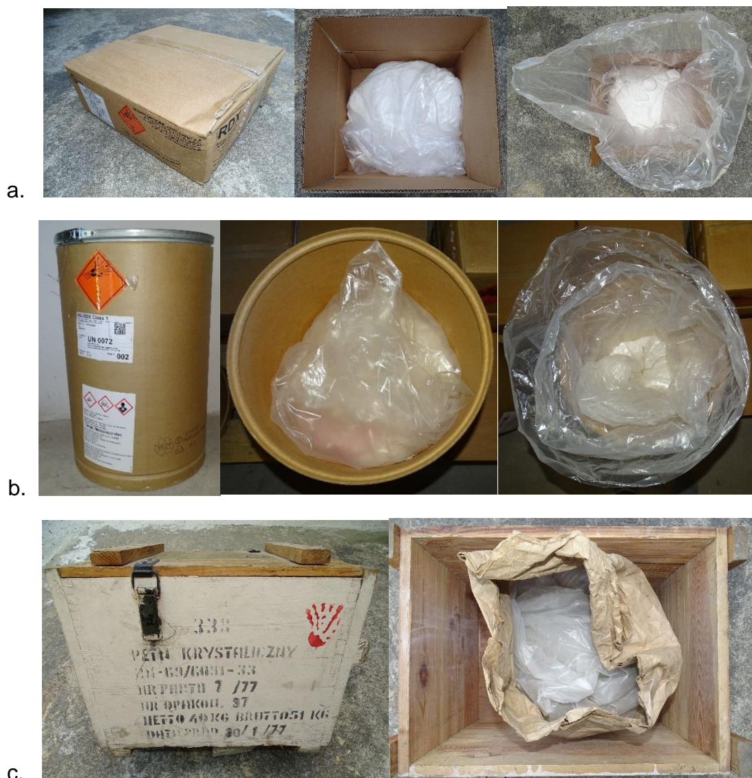
Fot. 1. Najczęściej stosowane pojemniki do przechowywania materiałów wybuchowych: a) pojemnik tekturowy z RDX zapakowanym w worek foliowy, b) pojemnik z grubej tektury z RDX zapakowanym w worek foliowy, c) drewniana skrzynia z pentrytem zapakowanym w worku foliowym włożonym w worek papierowy
