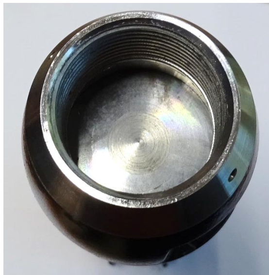
Fot. 4. Pocisk moździerzowy 60 mm z przegrodą – widok od strony oka pod zapalnik
