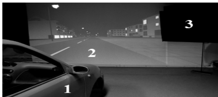
Rys. 1. Wygląd symulatora jazdy samochodem oraz modułu reklamy LED: 1 – widok fragmentu kabiny kierowcy, 2 – ekran, na którym wyświetlana jest symulacja drogi, 3 – moduł rzeczywistej reklamy LED
