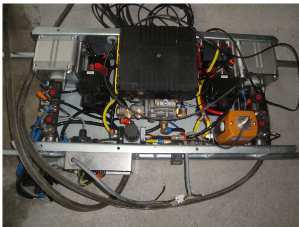
Rys. 5. Widok wnętrza skrzyni, z podzespołami układu hamulcowego PIMR-EBS [9], która jest montowana pomiędzy osiami zawieszenia kół
