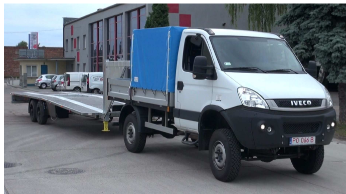
Rys. 7. Zestaw pojazdów drogowych samochód Iveco Daily D35 ,4x4, sprzęgnięty z naczepą NGS-10,4 (9,6t na dwóch osiach zawieszenia; nacisk na kulę zaczepu - 0,8t);
