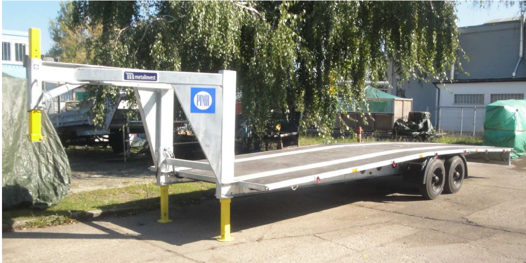
Rys. 6. Naczepa NGS-10,4 ze zmienną wysokością podłużnic, by przewożony Zestaw Pojazdów Gąsienicowych nie przekroczył dopuszczalnej wysokości skrajni drogowej
