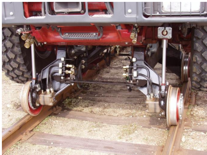
Rys. 3. Przykład pojazdu kategorii 9A z zamontowanym układem hydraulicznym napędu i hamowania rolek [archiwum IPS „TABOR”]
