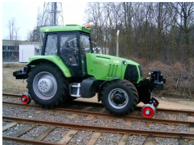
Rys. 5. Przykład pojazdu kategorii 9C z przestawnym układem rolek [archiwum IPS „TABOR”]
