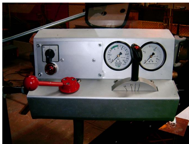
Rys. 11. Elementy układu hamulcowego zabudowanego w kabinie pojazdu szynowego [archiwum IPS „TABOR”]
