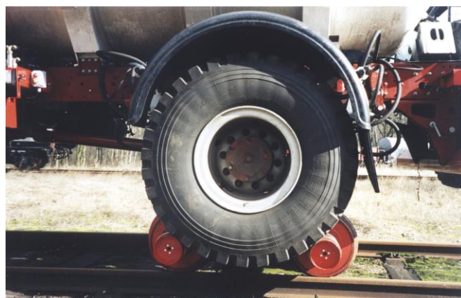
Rys. 4 Przykład pojazdu kategorii 9B z bębnowym układem ciernym napędu rolek [archiwum IPS „TABOR”]
