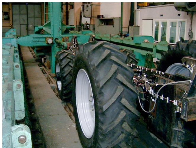
Rys. 8. Próba rozciągania pojazdu szynowo drogowego [archiwum IPS „TABOR”]
