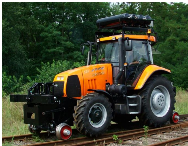
Rys. 10. Przykład pojazdu wyposażonego w zbiorniki służące do hamowania składem wagonów [archiwum IPS „TABOR”]
