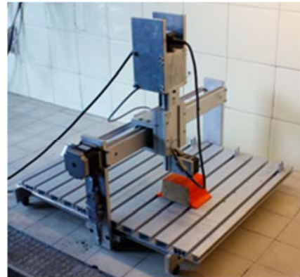
Rys. 1. Prototypowy, laserowy profilometr do badań surowych powierzchni odlewów, modeli, rdzennic.
