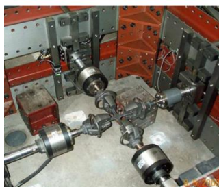
Rys. 8. Stanowiska pozwalające na rozciąganie próbki w dwóch prostopadłych osiach jednocześnie [5].
