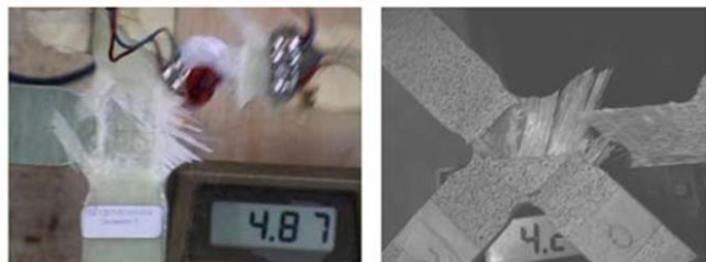
Rys. 9. Próbkę do dwukierunkowego rozciągania blachy [4].
