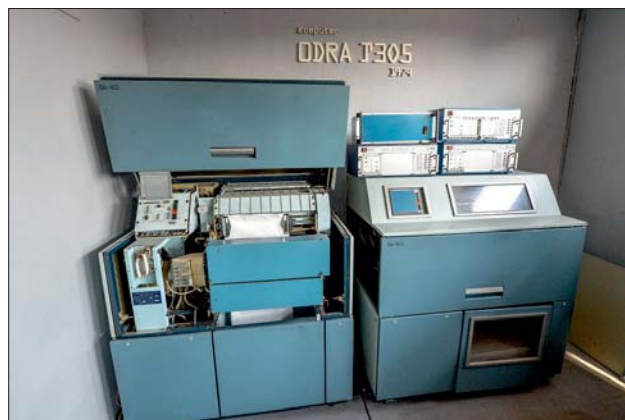
Ryc. 1. Komputer Odra 1305 produkcji zakładów Elwro we Wrocławiu – 1974 r. ( http://wyborcza.pl/alehistoria )
