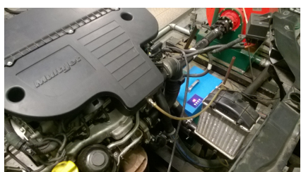
Rys. 2. Doprowadzenie ozonu do silnika Fiat 1,3 JTD 16V MULTIJET
