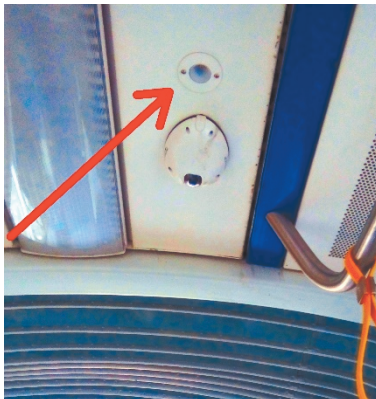
Ryc. 4. Zdjęcie kamery KW03 oraz znajdującego się obok niej mikrofonu rejestrującego sygnały akustyczne z wnętrza pojazdu (wskazany czerwoną strzałką).
