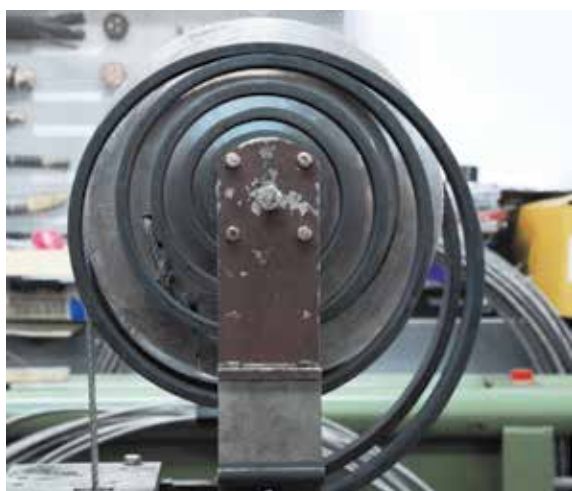
Rys. 6. Układ sprężyn poddany maksymalnemu obciążeniu
