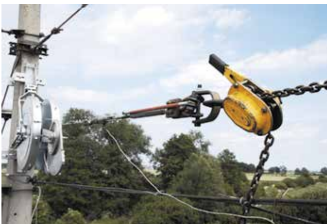
Rys. 14. Test urządzenia naprężającego, widoczny naciąg łańcuchowy i czujnik siły
