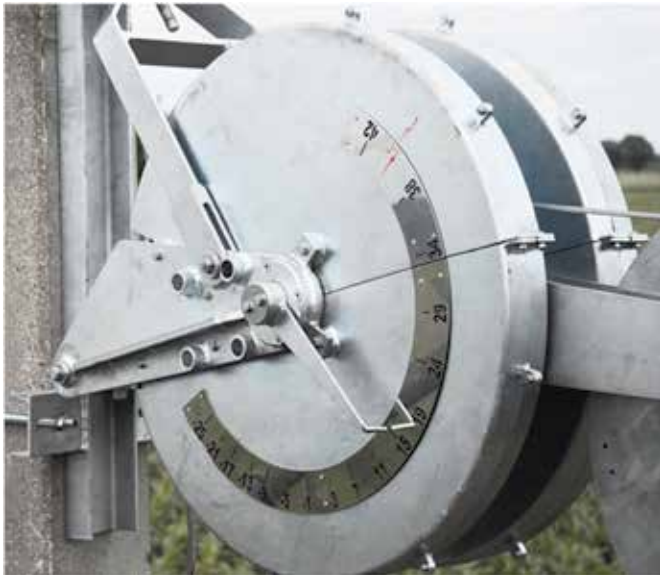
Rys. 13. Skala do regulacji urządzenia
