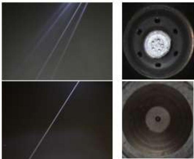
Fig. 10. Differences in injection for different types of injectors Rys. 10. Różnice wtrysków dla różnych typów wtryskiwaczy
