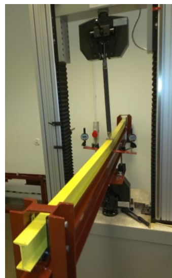
Rys.1. Stanowisko badawcze zwichrzenia dwuteownika I80 wykonanie stanowiska: dr inż. K. Dziewiecki, mgr inż. Z. Mazur: U T-H w Radomiu
