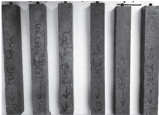
CEM VI (45% S + 10% LL) w roztworze \text{Na}_2\text{SO}_4 po 7 miesiącach trwania badania w 8°C
