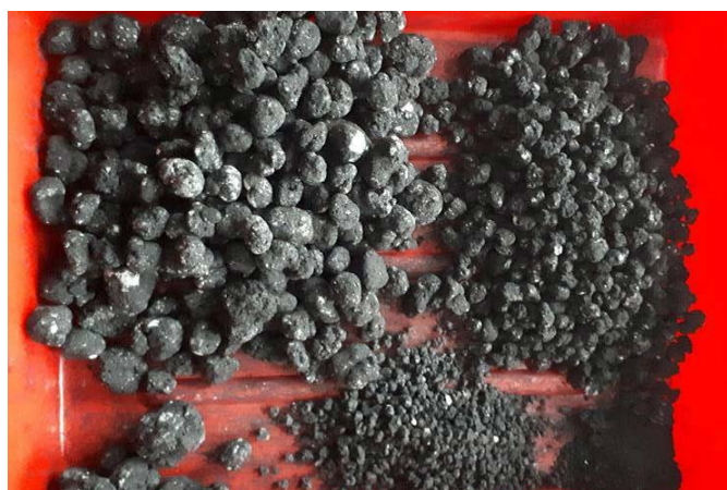
Rys. 8. Muły węglowe (PG SILESIA), sadza, dolomit (próbka 2). Fot. J. Feliks
