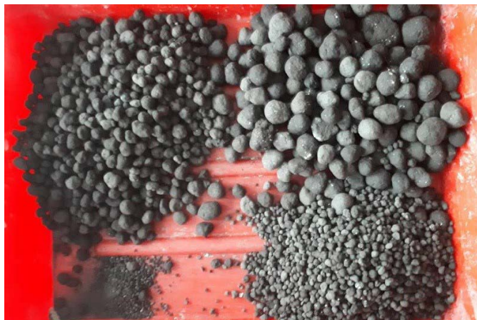
Rys. 9. Muły węglowe (PG SILESIA), pył węglowy (LEAG), dolomit (próbka 3). Fot. J. Feliks
