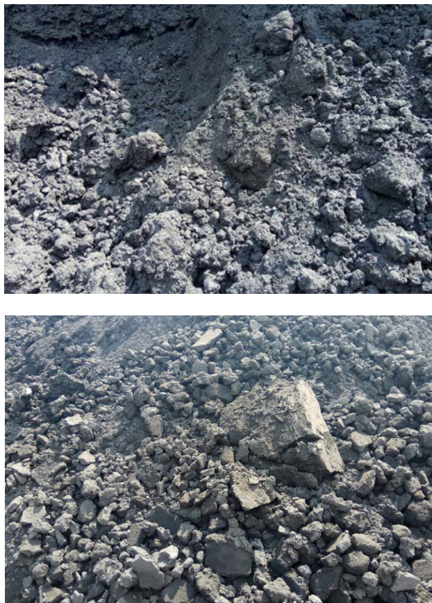
Rys. 1. Muły węglowe po odwadnianiu na prasach filtracyjnych (placki filtracyjne) zdeponowane na składowiskach kopalni PG SILESIA (lipiec 2018 r.). Fot. M. Wienczek
