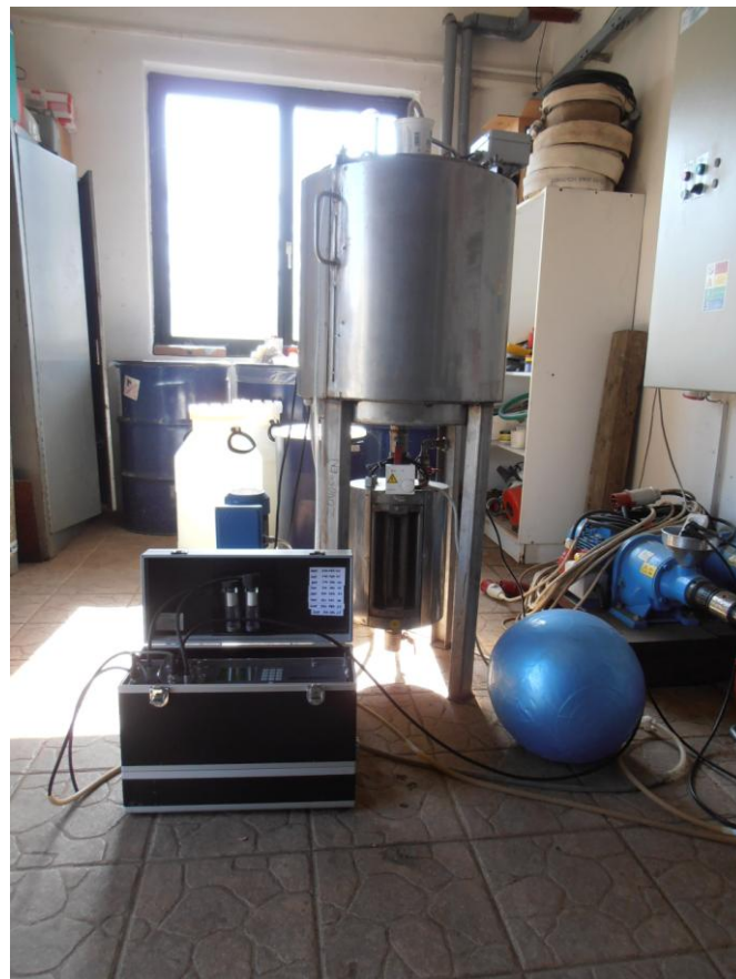
Fig. 2. Configuration of the experimental equipment for dry fermentation Rys. 2. Budowa urządzenia do suchej fermentacji
