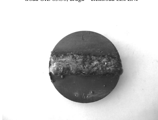
Rys. 4. Powierzchnia próbki wstępnie żłobiona palnikiem laserowym a następnie napawana elektrodą EŻFENI
