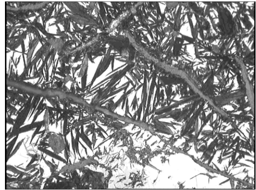
Rys. 7. Mikrostruktura warstwy napawanej
