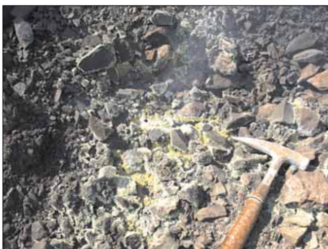
Fig. 3. Wykwity siarki rodzimej (żółta) i salmiaku rodzimego (biały) na powierzchni płonącej hałdy w rejonie Rybnika
