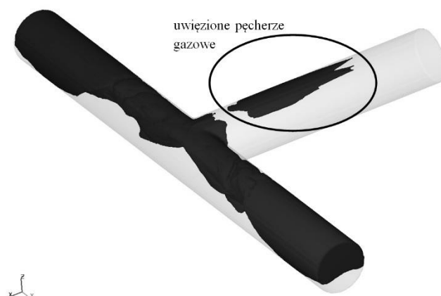
Rys. 5. Uwięzione pęcherze gazowe po czasie 1,1 s
