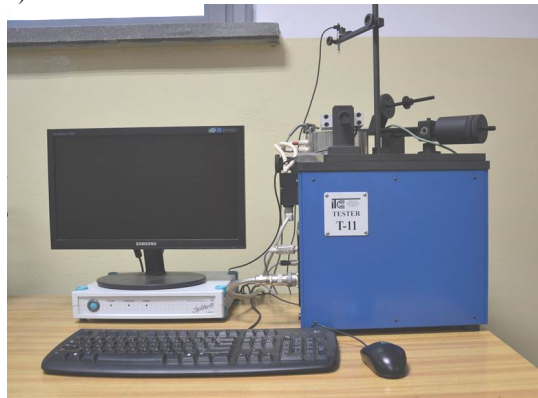
Rys. 1. Zdjęcie testera tribologicznego T-11 (a) oraz schemat węzła tarcia typu kulka-tarcza (b)
