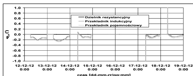
Rys. 5. Zmiany wartości kątów fazowych harmonicznej podstawowej napięcia w okresie pomiarowym
