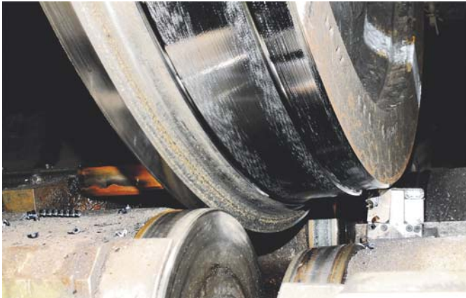
Fot. 3. Odnowa profilu koła na tokarce podtorowej
