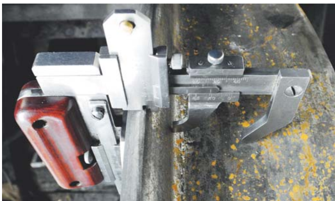
Fot. 1. Przykład zużycia ściernego obrzeża koła, mierzonego specjalistyczną suwmiarką Źródło: oprac. własne.
