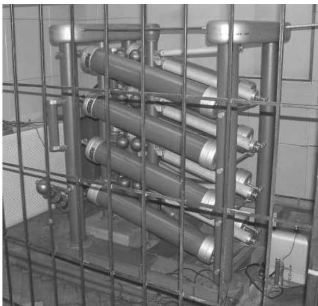
Rys. 9. Udarowy generator Marxa 500 kV, 2,2 kWs, produkcji TUR Dresden
