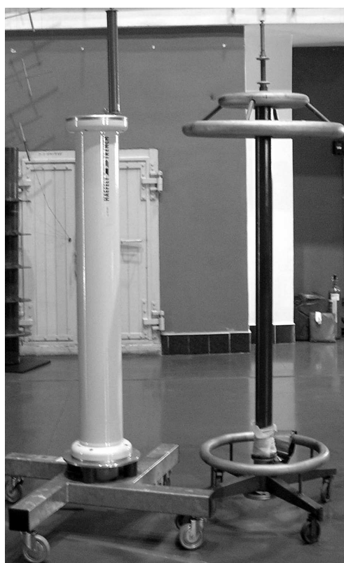
Rys. 12. Dzielnik uniwersalny Haefely RCZ 500, 500 kV udar/180 kV AC/DC z 1995. Dzielnik rezystancyjny TUR z 1977 r. do pomiaru napięć udarowych 700 kV, R=10 \text{ k}\Omega
